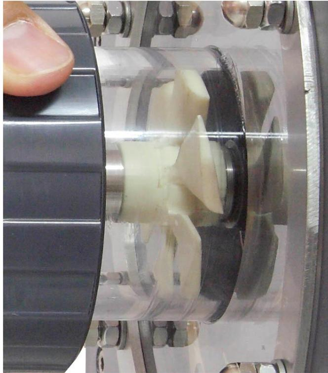
La construcción transparente de las partes importantes de la turbina permiten una inmejorable vista de todo el conjunto en funcionamiento.
