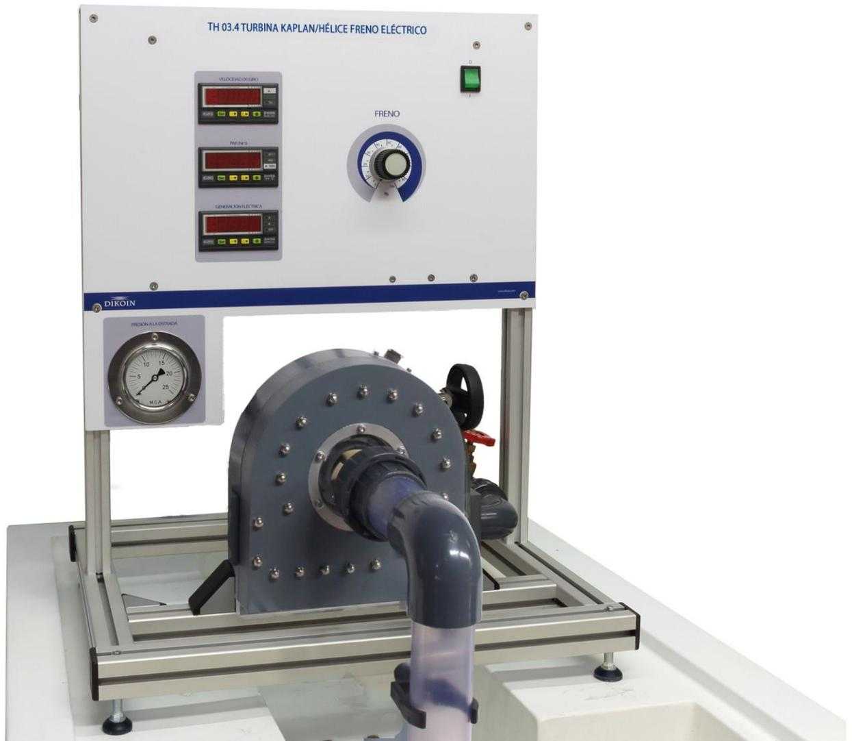
El equipo TH 03.4 simula una instalación a pequeña escala con una turbina Kaplan/Hélice, y está diseñado para el estudio y visualización tanto del comportamiento como de sus características.
